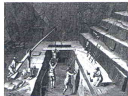
Mineralogie, Ardoises D'Anjou. Travail de la Carrière Ouverte et Outils. Revuell de Planches, sue Les Sciences, Les Arts Liberaux, et Les Arts Mechaniques, Avec Explication , Diderot-D'Alembert. (Courtesy of NewsBank, Inc.) [click image for larger view]
